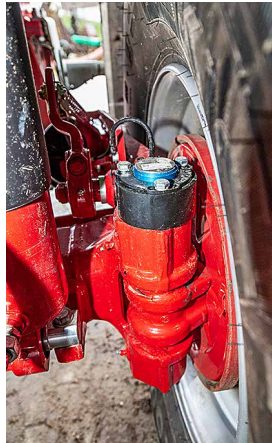
Die Hydac-Lenkung besteht aus einer separaten Steuerbox, einem Load-sensing-Block und einem kleinen Inertialsensor.
