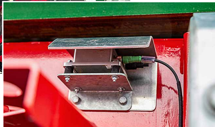
Die Hydac-Lenkung besteht aus einer separaten Steuerbox, einem Load-sensing-Block und einem kleinen Inertialsensor.
